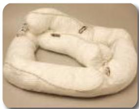
A barreira é constituída de material absorvente na forma de flocos ou tiras envoltos por uma tela resistente e não-tecido. Os ganchos em suas extremidades podem ser interligados uma barreira à outra para formar o comprimento desejado. Flutuam indefinidamente antes e depois de totalmente saturadas de óleo. São recomendadas para contenção e limpeza de vazamentos de óleos em águas de lagos, rios, córregos, mar, portos e marinas.
