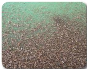
A turfa é recomendada para a contenção e controle de vazamentos e derramamentos de óleos e líquidos agressivos no meio ambiente natural e no meio ambiente industrial como refinarias e indústrias químicas e petroquímicas. Sua aplicação para absorver pode ser realizada em superfícies como concreto, asfalto, solo e água.
