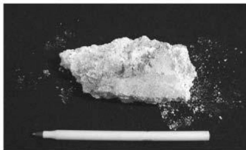
Figura 2: Efeito do lascamento explosivo após ensaio de resistência ao fogo
