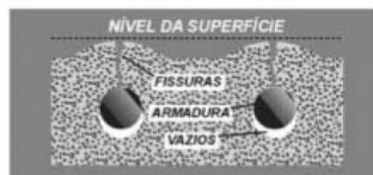
Figura 1: Fissuras de assentamento
